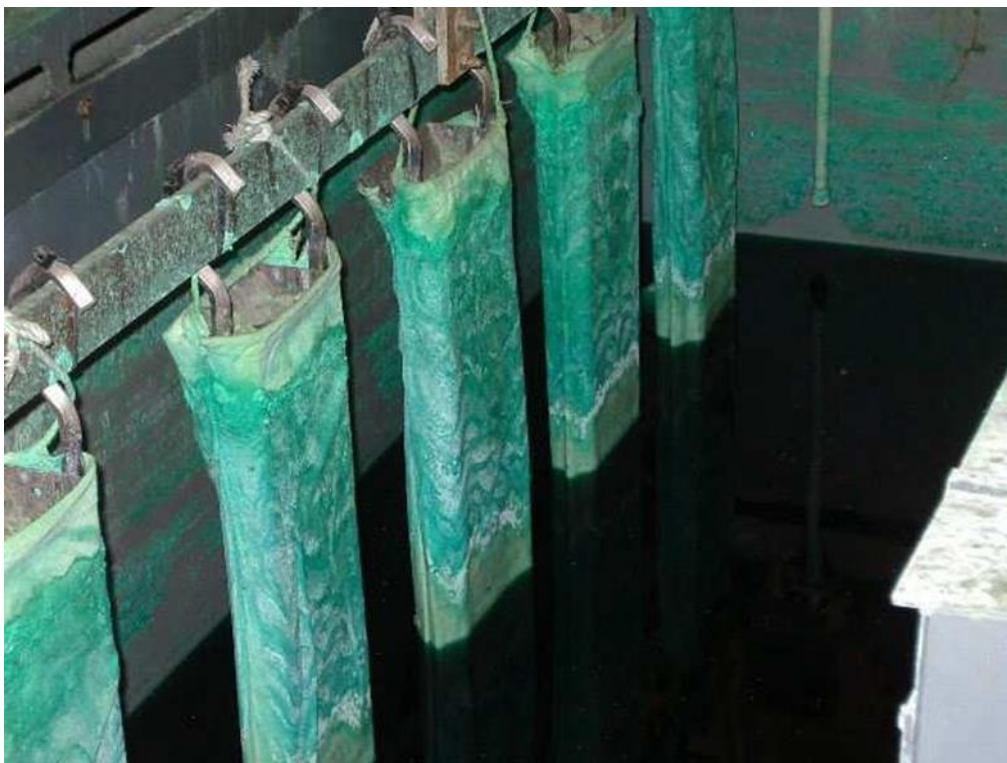
Foto 2 - Cestelli anodici in una vasca di nichelatura
