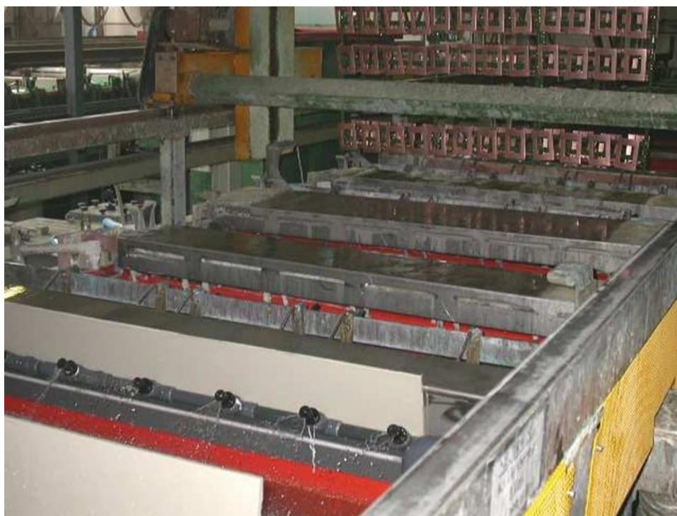
Foto n. 5: metallizzazione chimica di placche per interruttori
